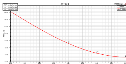
Gambar 5 Grafik return loss hasil iterasi elemen tunggal
