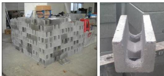
Gambar 1 Balok bataton pracetak
