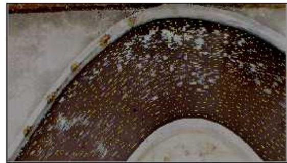
Gambar 25. Pola Aliran Permukaan  $Q_1T_k$
