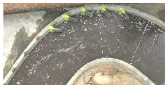
Gambar 20. Distribusi Kecepatan Aliran Permukaan Q<sub>2</sub>S<sub>3</sub>
