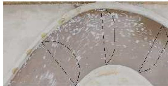
Gambar 17. Distribusi Kecepatan Aliran Permukaan Q<sub>2</sub>T<sub>k</sub>
