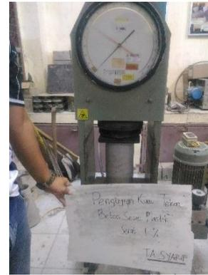
Gambar 3. Pengujian kuat tekan beton
