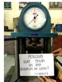
Gambar 1. Pengujian kuat tekan mortar
