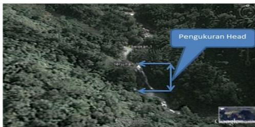
Gambar 2.2. Pengukuran Head
