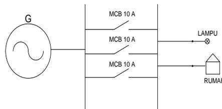
Gambar 3.6. Sistem Pembangkit ke Beban
