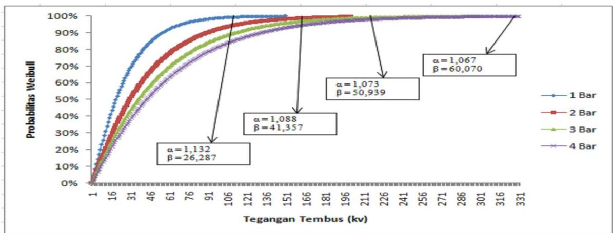
**Gambar 4.3** Kurva tegangan tembus isolasi gas nitrogen (N<sub>2</sub>) elektroda jarum-jarum jarak sela 0,5 cm dengan tekanan 1-4 bar
