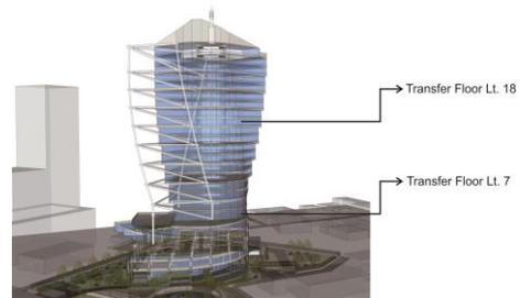
**Gambar 3.7** Potongan 3D dan Perletakan *Transfer floor*
