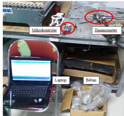
Gambar 9 Posisi Dinamometer Saat Kalibrasi
