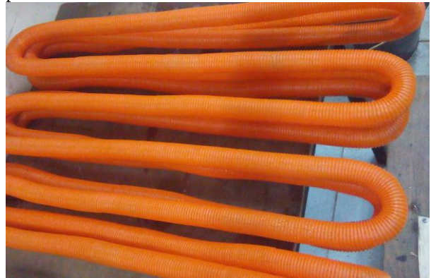
Gambar 5 Tube bagian luar evaporator
