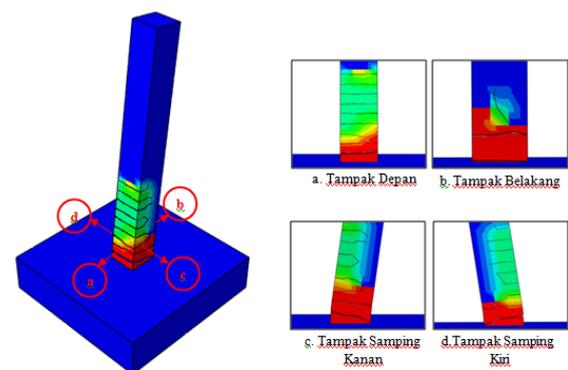
Gambar 20 Pola Penjalaran Retak Kolom Semi Pracetak pada Kolom Cast in Place dengan Mutu Beton Pracetak 20 MPa
