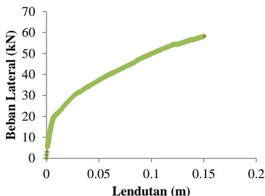
Gambar 11 Perbandingan Beban-Lendutan Dengan Mutu Beton Pracetak 16 MPa
