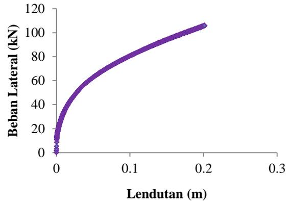
Gambar 12 Perbandingan Beban-Lendutan dengan Mutu Beton Pracetak 20 MPa
