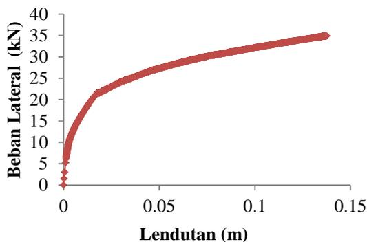
Gambar 10 Perbandingan Beban-Lendutan Dengan Mutu Beton Pracetak 12 MPa
