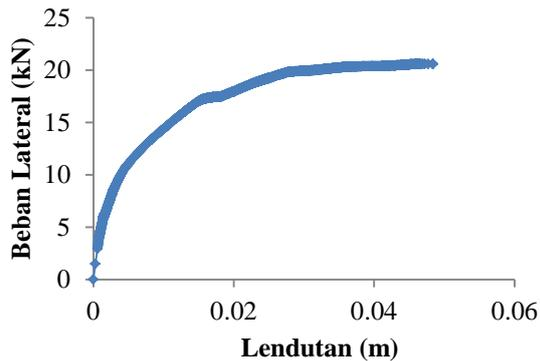
Gambar 9 Perbandingan beban-lendutan dengan mutu beton pracetak 8 MPa
