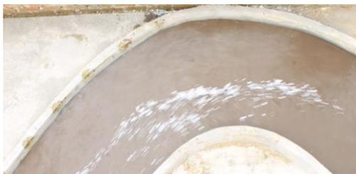
Gambar 13. Pengujian tanpa *krib* pada debit 0.0056 m<sup>3</sup>/detik
