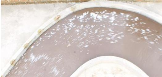
Gambar 11. Pengujian tanpa *krib* pada debit 0.00134 m<sup>3</sup>/detik
