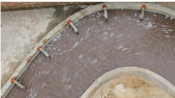
Gambar 30. Pengujian dengan variasi *krib* 50 cm pada debit 0.00134 m<sup>3</sup>/detik
