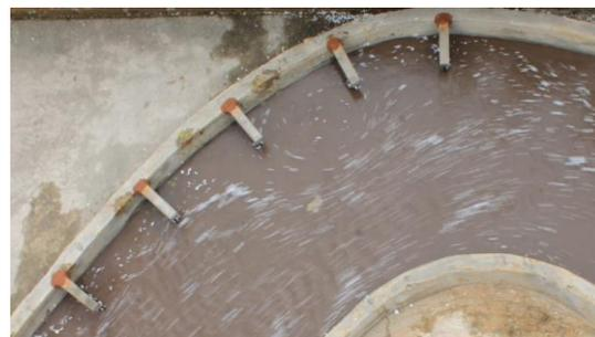
Gambar 22. Pengujian dengan variasi *krib* 40 cm pada debit  $0.00298 \text{ m}^3/\text{detik}$
