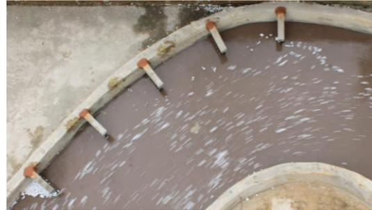
Gambar 20. Pengujian dengan variasi *krib* 40 cm pada debit  $0.00134 \text{ m}^3/\text{detik}$
