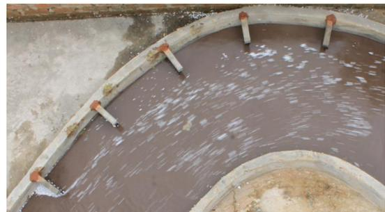
Gambar 26. Pengujian dengan variasi *krib* 50 cm pada debit 0.00134 m<sup>3</sup>/detik
