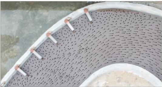
Gambar 19. Pengujian dengan variasi *krib* 30 cm pada debit  $0.0056 \text{ m}^3/\text{detik}$  (setelah digambarkan dengan *AutoCad* 2007)
