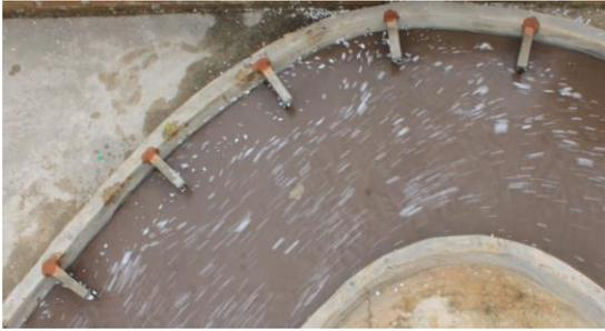
Gambar 28. Pengujian dengan variasi *krib* 50 cm pada debit 0.00298 m<sup>3</sup>/detik
