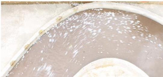
Gambar 12. Pengujian tanpa *krib* pada debit 0.00298 m<sup>3</sup>/detik
