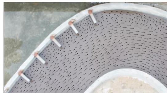
Gambar 17. Pengujian dengan variasi *krib* 30 cm pada debit 0.00298 m<sup>3</sup>/detik (setelah digambarkan dengan *AutoCad* 2007)
