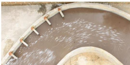
Gambar 14. Pengujian dengan variasi *krib* 30 cm pada debit 0.00134 m<sup>3</sup>/detik
