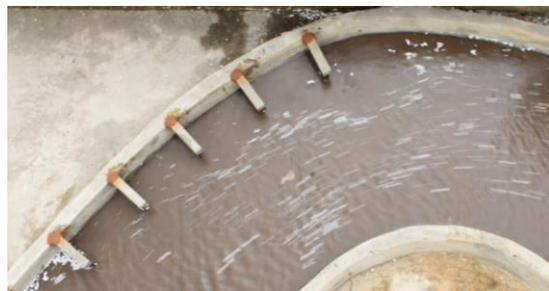
Gambar 16. Pengujian dengan variasi *krib* 30 cm pada debit 0.00298 m<sup>3</sup>/detik
