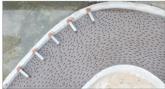
Gambar 15. Pengujian dengan variasi *krib* 30 cm pada debit 0.00134 m<sup>3</sup>/detik (setelah digambarkan dengan *AutoCad* 2007)
