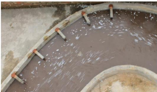
Gambar 24. Pengujian dengan variasi *krib* 30 cm pada debit 0.0056 m<sup>3</sup>/detik
