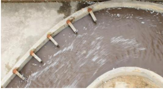
Gambar 18. Pengujian dengan variasi *krib* 30 cm pada debit  $0.0056 \text{ m}^3/\text{detik}$
