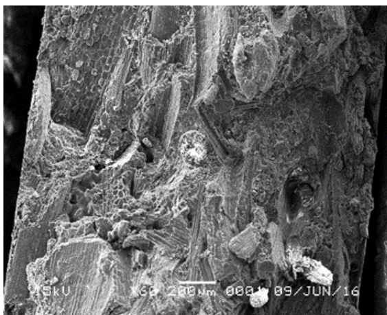
Gambar 9 Hasil Pengamatan Morfologi WPC Rasio PP/SPS (50/50), MAPP (2%) dan Selulosa (56.24%) dengan SEM
