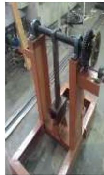
Gambar 3.12 Konstruksi Alat Uji Impak Setelah Pengujian
