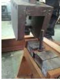
Gambar 3.7 Benda Uji Dimasukkan Ke Dalam *Fixture*
