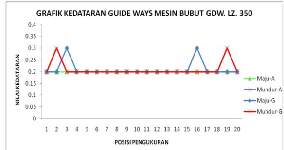
Gambar 5. Hasil pengukuran kedataran guide way no 1 mesin bubut MB2
