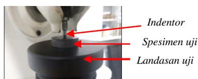
Gambar 5 Proses Pengujian Kekerasan
