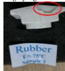
Gambar 15. Porositas spesimen cetakan *sillicone rubber*
