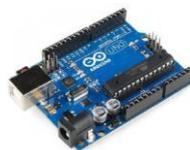
**Gambar 2.3 Bentuk Fisik Arduino Uno**
