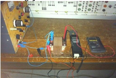
Gambar 4.12 Pengujian beban nol transformator satu fasa
