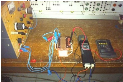
Gambar 4.17 Pengujian beban nol transformator tiga fasa
