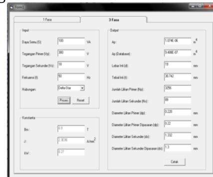
Gambar 4.6 Hasil program perancangan transformator tiga fasa
