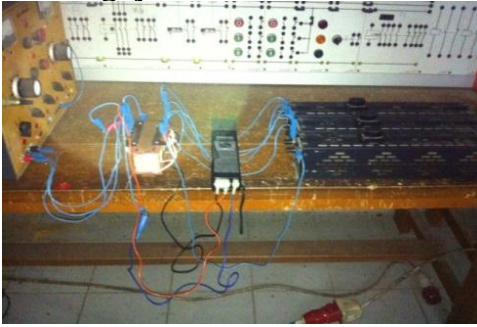
Gambar 4.19 Pengujian beban penuh transformator tiga fasa
