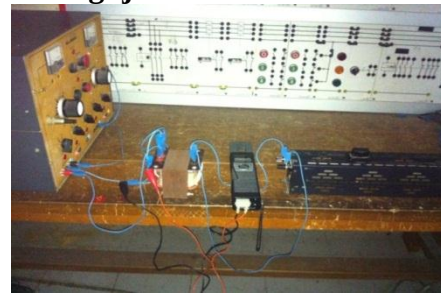
Gambar 4.14 Pengujian beban penuh transformator satu fasa
