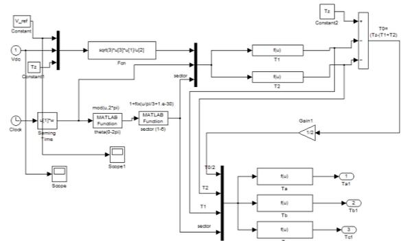
Gambar 4.2 Model *Simulink* untuk Waktu *Switching*
