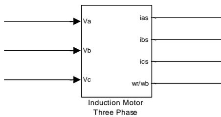
Gambar 3.6 Model *Subsystem* Motor Induksi Tiga Fasa
