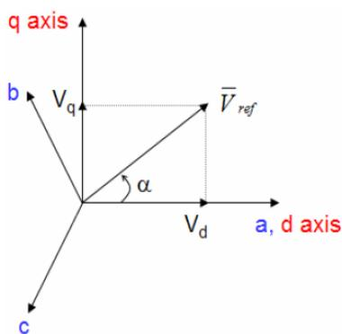
Gambar 3.1 Vektor ruang tegangan dan komponennya dalam (d,q)
