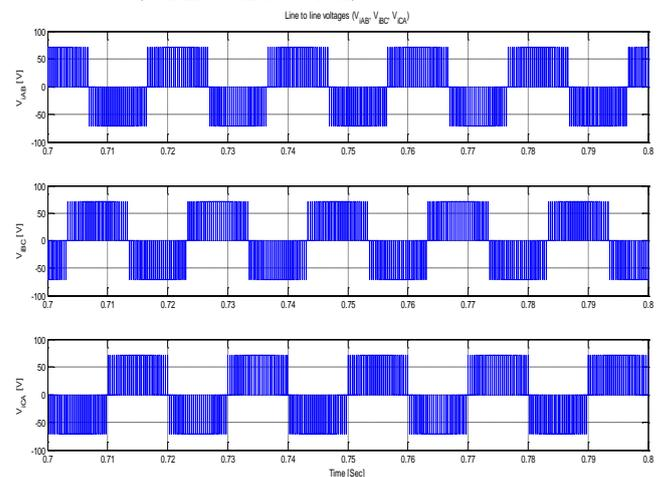
Gambar 4.3 Tegangan Output Inverter Fasa ke Fasa
