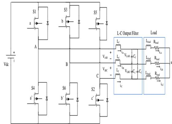
Gambar 2.2 Inverter PWM tiga fasa Sumber Tegangan
