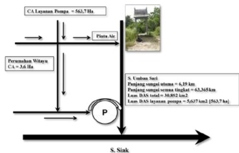
Gambar 6. Skema aliran dan rencana letak pompa
