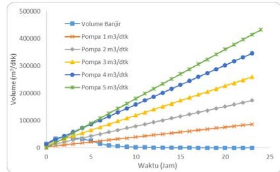
Gambar 7. Analisis Pemompaan untuk Hujan Efektif dengan Durasi 5 Jam Kala Ulang 5 Tahun
