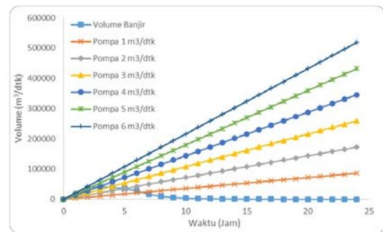
Gambar 8. Analisis Pemompaan untuk Hujan Efektif dengan Durasi 5 Jam Kala Ulang 10 Tahun
