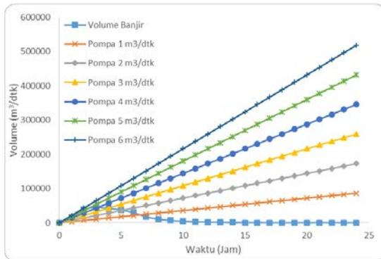
Gambar 9. Analisis Pemompaan untuk Hujan Efektif dengan Durasi 5 Jam Kala Ulang 25 Tahun
