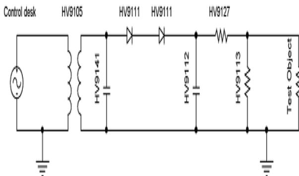
Gambar 4 Rangkaian pengujian tegangan korona pada tegangan dc
