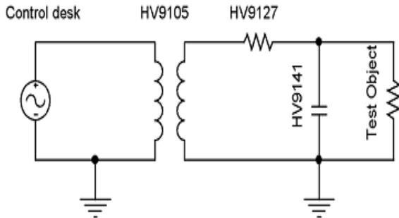
Gambar 3 Rangkaian pengujian tegangan korona pada tegangan ac
