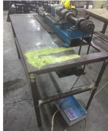
**Gambar 6** Alat Las Gesek Rotari Setelah *Redesign*
