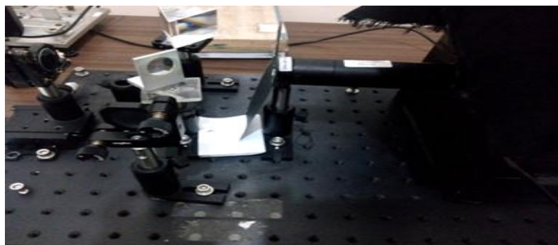
Gambar 4. Layout komponen interferometer Michelson buatan sendiri.
