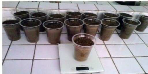
Gambar 2. Menimbang massa tanah menggunakan timbangan elektronika
