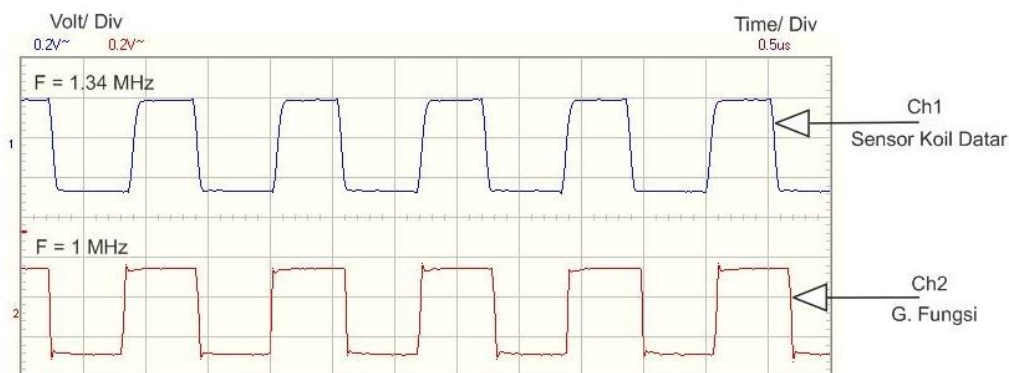
Gambar 5. Tampilan kalibrasi sensor menggunakan osiloskop USB
