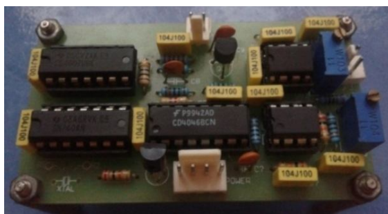
Gambar 4. Rangkaian osilator LC dengan inverter dan Op-Amp
