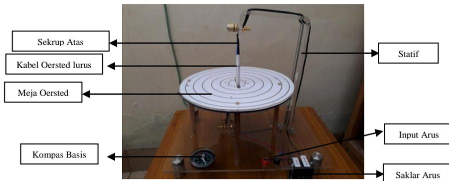
Gambar 1. Alat Eksperimen Oersted
