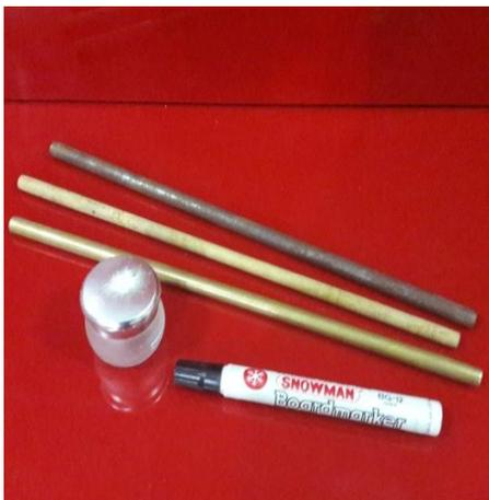
Gambar 5. Detektor Sifat Magnetisme Bahan
