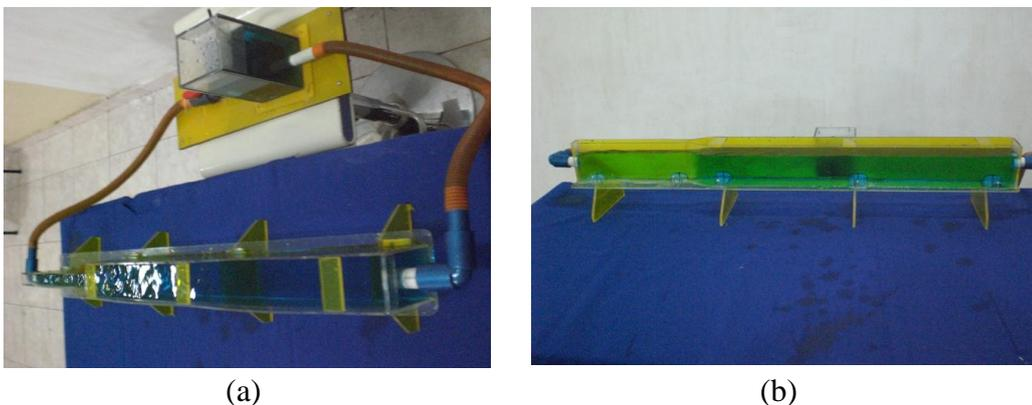
Gambar 1 Alat percobaan aliran laminar dan turbulen dilihat dari sudut kiri atas (a) depan (b)
