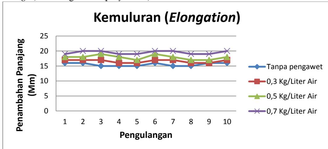
Gambar 2. Nilai rata-rata kemuluran benang PA (*polyamide*) berdiameter 0,2 cm yang tidak diawetkan dengan diawetkan dari sepuluh kali ulangan pengujian.
