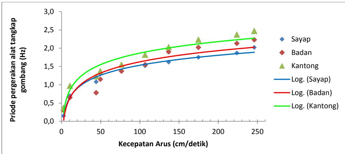
Gambar 6: Grafik pergerakan alat tangkap gombang (Hz).
