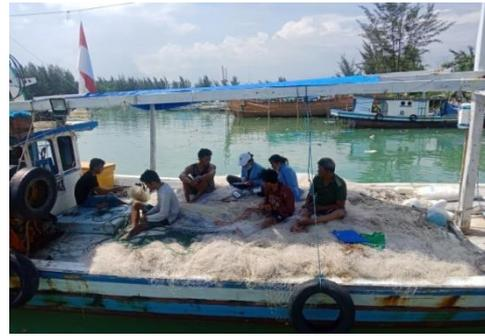
Gambar 3. Alat tangkap jaring insang hanyut ukuran mata 10,16
