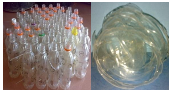
Gambar 1. Rangkaian Botol Plastik dan Media Isi Potongan Plastik yang Digunakan.
