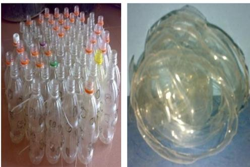
**Gambar 1. Rangkaian Botol Plastik dan Media Isi Potongan Plastik yang Digunakan.**
