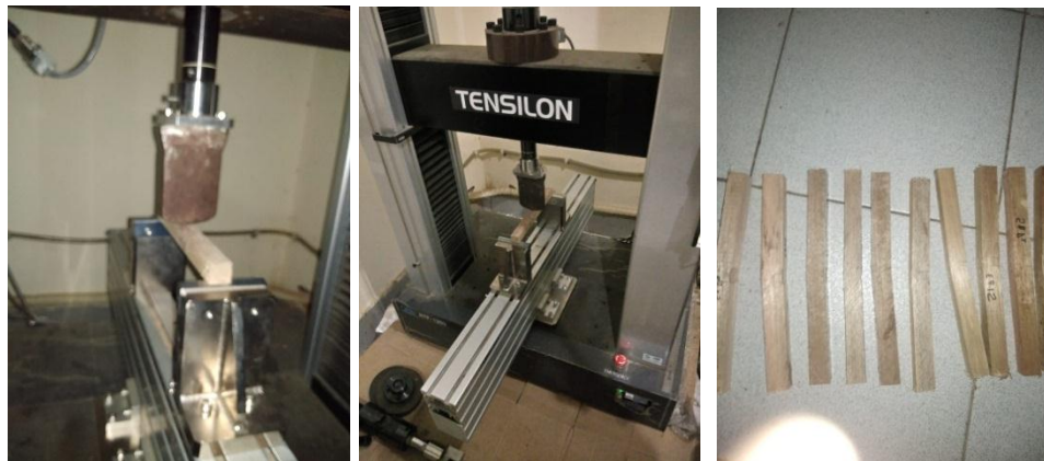
Gambar 1. Pengujian Sifat Mekanis Kayu Spesimen
