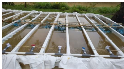
Gambar 2. Model unit pengolahan air Sungai Sail menggunakan biorafia.
