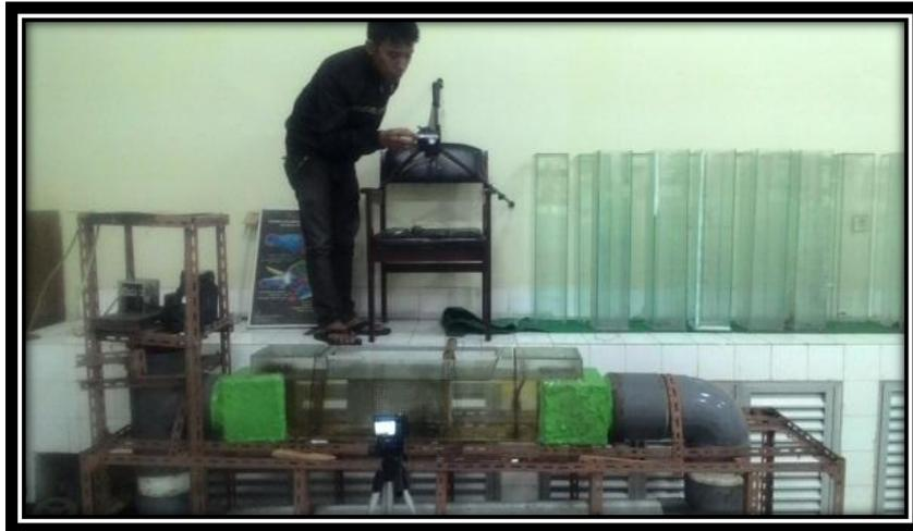
Gambar 3. Prosedur pengambilan data dengan kamera di *flume tank*
